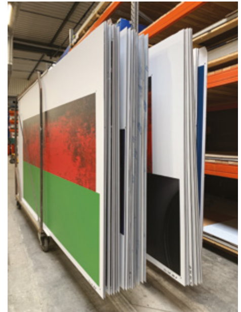
Une fois imprimées, les plaques d'aluminium ou de polycarbonate sont stockées pour ensuite être découpées sur mesure.
